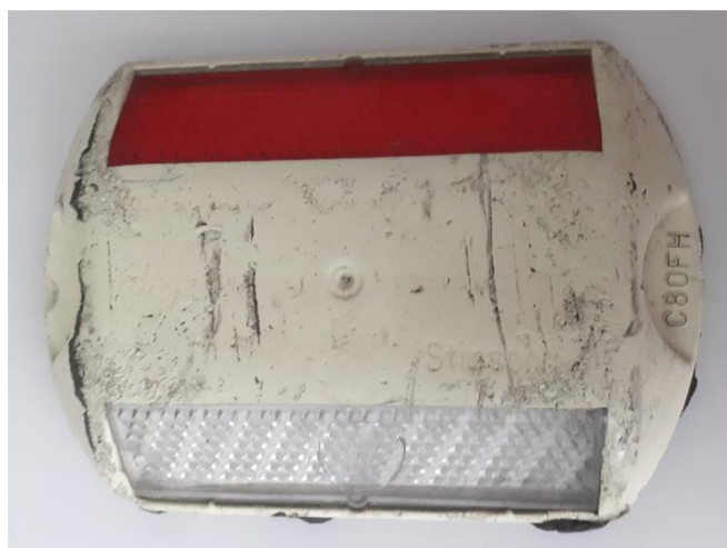
Рисунок 9. Катафот, вырванный колесами транспортных средств со старого асфальтобетонного покрытия (фото авторов)
