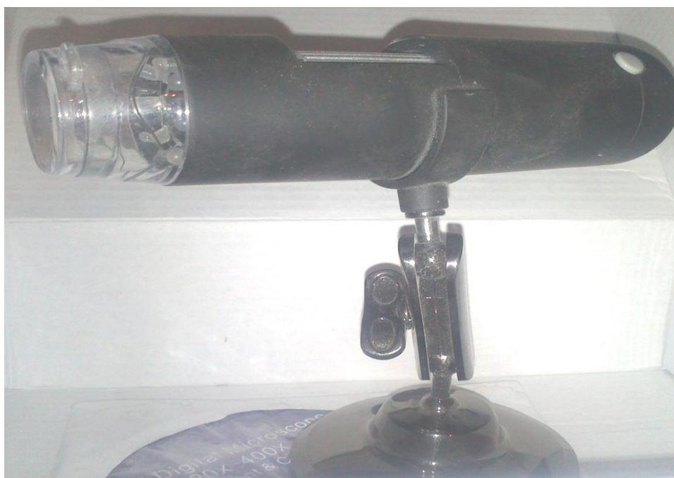
Рисунок 10. Цифровой микроскоп с 200-кратным увеличением [3]
